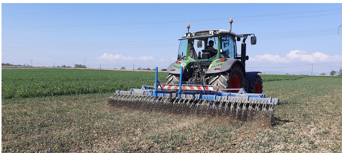
Désherbage mécanique des lentilles et camelines. Photo/FloraOgeron
